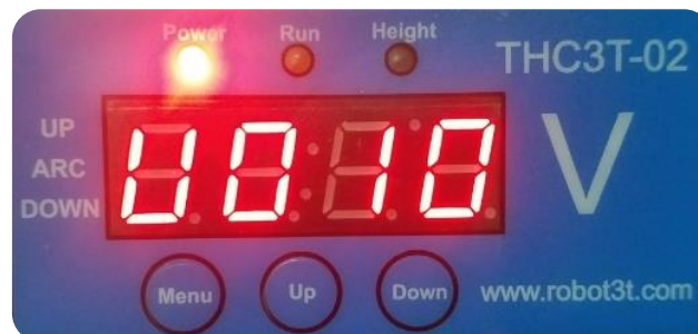
Fig18. Voltage set-point parameter
